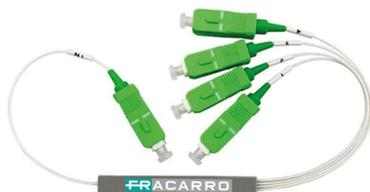
**Partitore ottico PLC miniaturizzato a 4 vie** adatto alla realizzazione dei ROE di edificio, con tecnologia planar waveguide che consente **bassissime perdite d'inserzione**. Adatto per una distribuzione ottica a basso costo ed a alte prestazioni, si presta all'utilizzo in innumerevoli tipologie installative.
